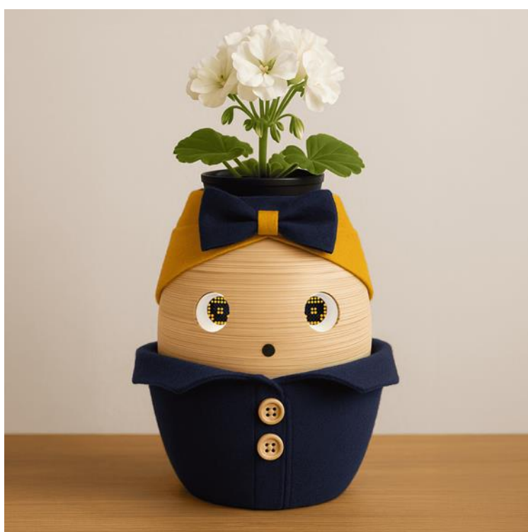
Ryc. 1. Holenderski robot Tinybot Tessa, który osobom z demencją ma przypominać m.in. o codziennych obowiązkach, odtwarzać wypowiedzi czy włączać ulubioną muzykę 16 .
