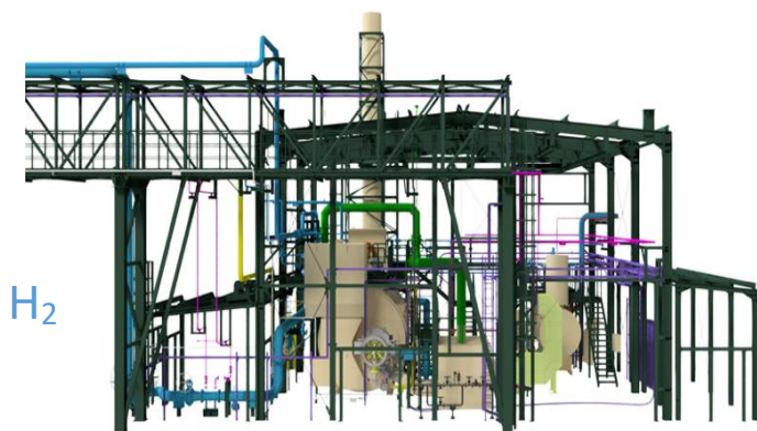
PCC ROKITA KOCIOŁ WODOROWY 15 t/h PARY PCC ROKITA HYDROGEN BOILER 15 t/h STEAM
