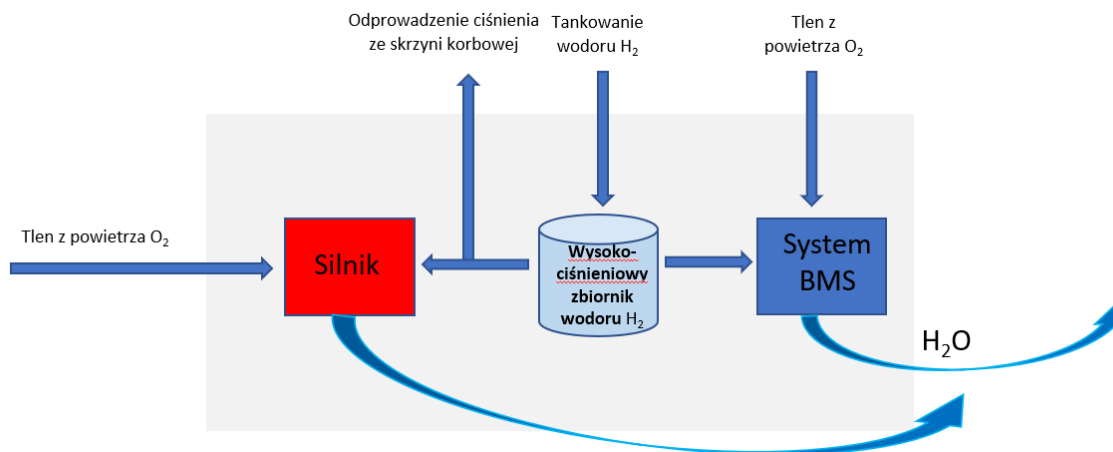
Rysunek 2 Ogólny schemat wykorzystywania wodoru jako paliwa w silniku z wewnętrzną komorą spalania na przykładzie auta marki BMW, opracowanie na podstawie 7 .
